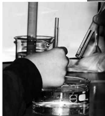
D28 | Oben: Schülerinnen testen im Labor die Kapillarkräfte des Wassers mit Hilfe von Glasröhrchen mit unterschiedlichem Durchmesser. Links: Unterschiedliche Steighöhe des Wassers in den Glasröhrchen durch die Kapillarwirkung, im Hintergrund Ablauf von Versuch D5b.
