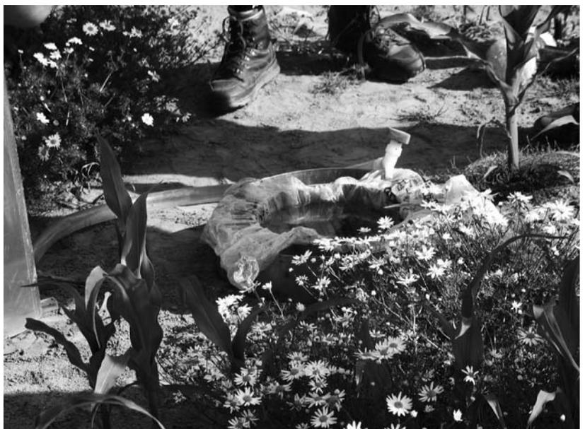
D32 | *Doppelringinfiltrometer bei der Messung auf einer Wiese (hier mit einer Mariott'schen Flasche, aus der genauso viel Wasser in den Innenring des Infiltrometers nachgeführt werden kann, wie versickert; damit kann der Wasserstand konstant gehalten werden).*
