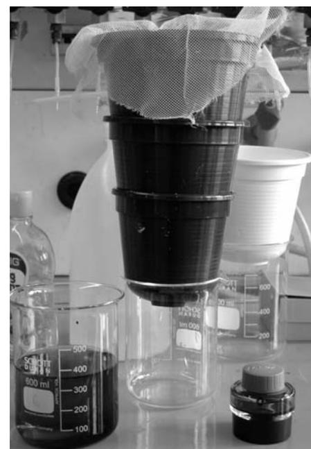
D23 | Versuchsaufbau mit mehreren Blumentöpfen.
