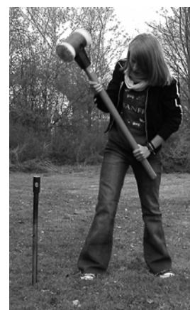
A33 | Probennahme mit Hilfe des Pürckhauer-Bohrstocks.
